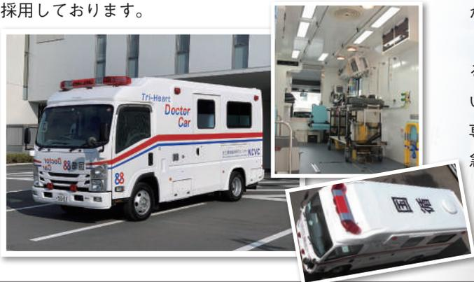
「動く集中治療室」として、生体情報モニタ・除細動器・人工呼吸器・超音波診断装置など ICU・CCU で患者を診療するのと同様の医療機器を搭載し、最大290kgの荷重が可能な昇降リフトも最大限拡張することにより重症例をより安全に移動・搬送できるようになりました。
