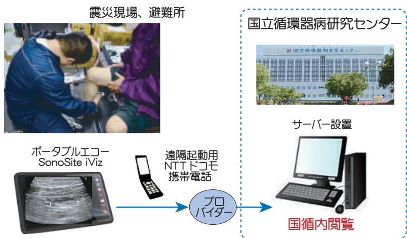
図2 災害時下肢血管エコー動画伝送システム(簡易図)
